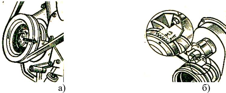
Рисунок 18. Установочные метки ВМТ для двигателей ЗМЗ-53 (а), ЗИЛ-130 (б)
