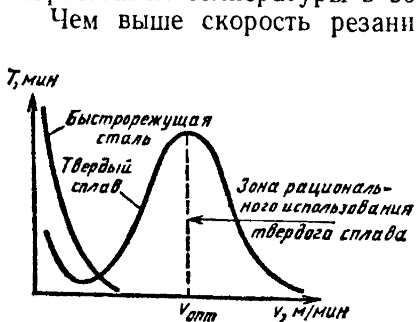
Рис. 3.23. Зависимость стойкости резца от скорости резания
