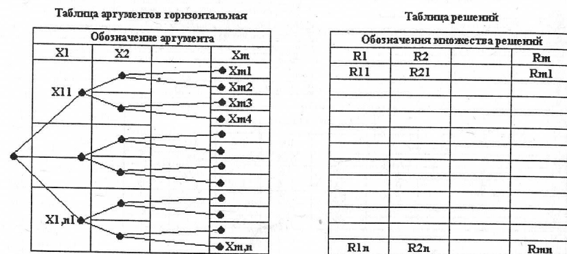
Рис. 5.15. Типовая структура односторонних ИЛТ
